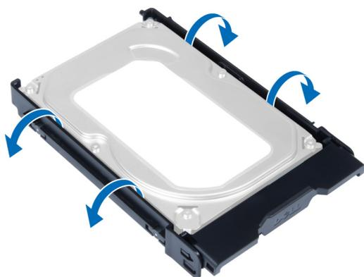
8. Приподнимите жесткий диск в вертикальном направлении, чтобы извлечь его из скобы жесткого диска.
