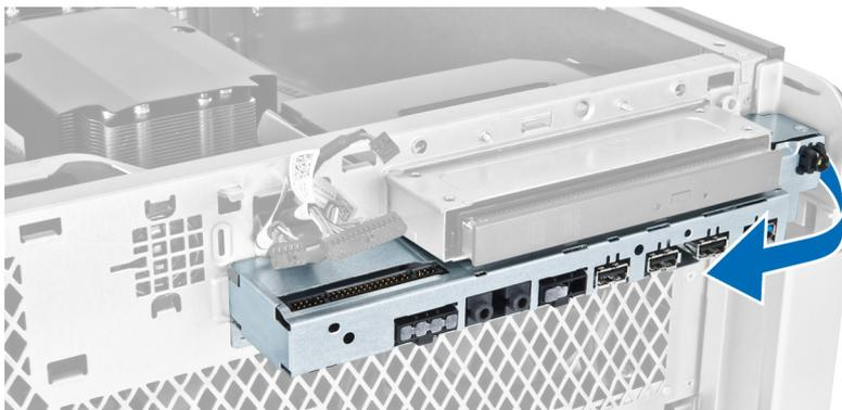
6. Выдвиньте противоположный край передней панели ввода-вывода наружу, чтобы снять модуль ввода-вывода с корпуса.
