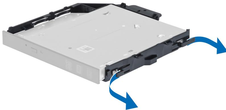
8. Приподнимите оптический дисковод и извлеките его из скобы.
