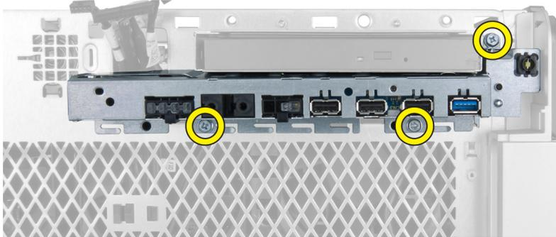
5. Потяните переднюю панель ввода-вывода в направлении от компьютера, чтобы высвободить край панели из зажима на корпусе.
