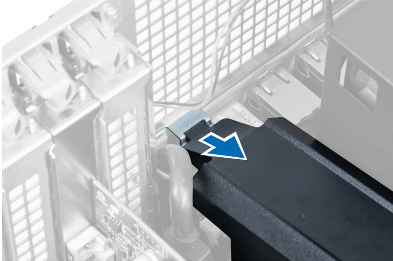
5. Нажмите на фиксаторы на основании воздуховода и поднимите его вверх, чтобы извлечь его из компьютера.
