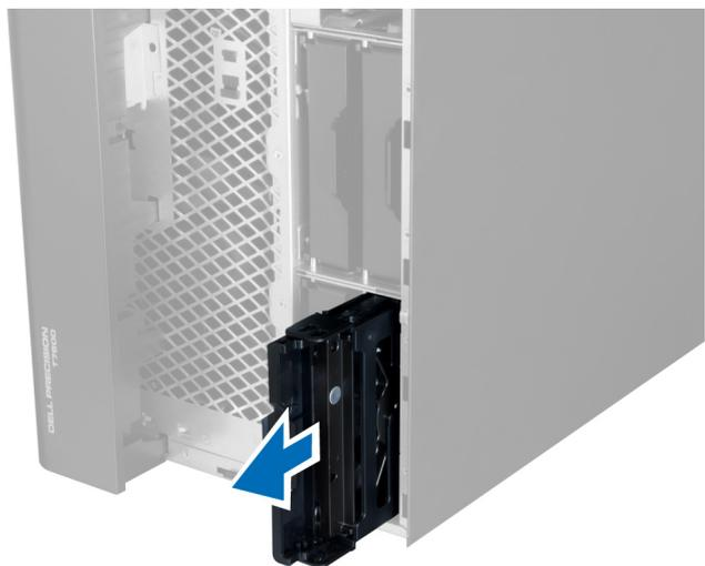
5. Если установлен второй жесткий диск, потяните карабин на скобе второго жесткого диска наружу.
