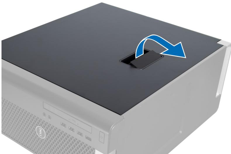
3. Поднимите крышку вверх под углом в 45 градусов и снимите ее с компьютера.
