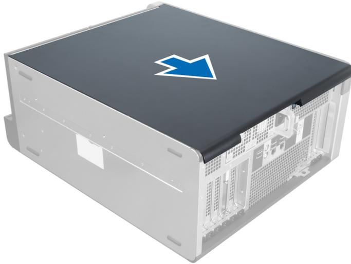
4. Приподнимите правую крышку вверх под углом в 45 градусов и снимите с компьютера.
