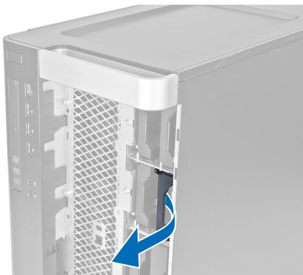
6. Сдвиньте вторую скобу жесткого диска наружу, чтобы извлечь ее из компьютера.
