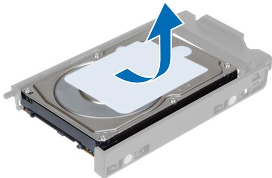
9. Если установлен жесткий диск 2,5", отведите фиксаторы наружу и приподнимите диск, чтобы извлечь его из контейнера для дисков 3,5".
