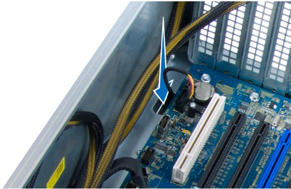
5. Выверните винты, которыми вентилятор жесткого диска крепится к передней части корпуса и извлеките вентилятор из компьютера.
