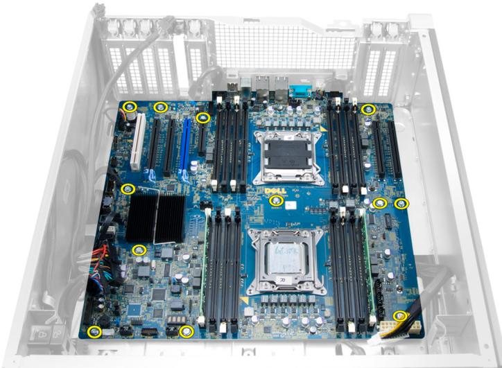
5. Поднимите системную плату вертикально вверх и извлеките ее из компьютера.
