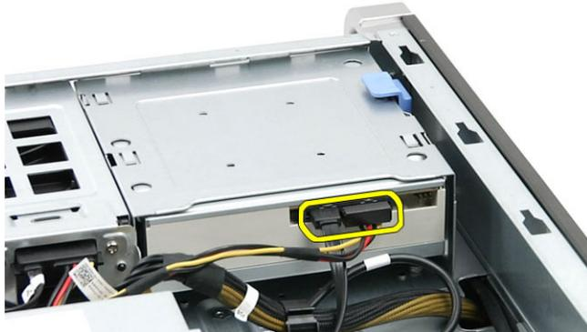
4. Нажмите фиксатор салазок (1) и сдвиньте оптический дисковод вперед, чтобы извлечь его из гнезда для дисков (2).
