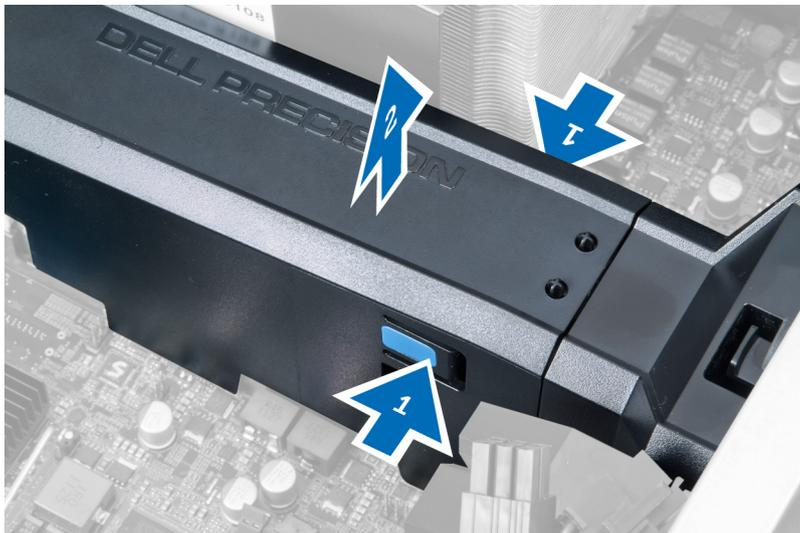
4. Нажмите на фиксаторы на обратной стороне модуля воздуховода, чтобы снять его с корпуса.
