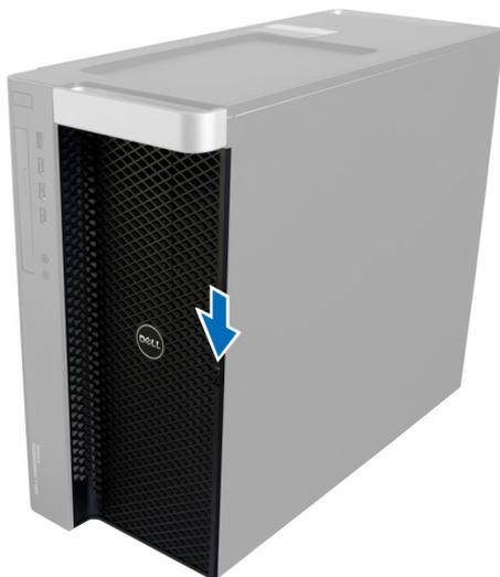
3. Удерживайте фиксатор нажатым и потяните переднюю крышку наружу, чтобы снять ее с компьютера.
